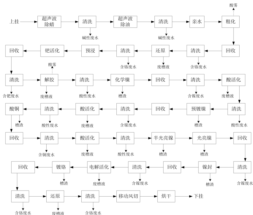
图 3.1-7 垂直升降式塑料挂镀线 (5#线) 工艺流程图
